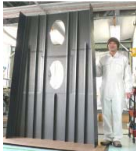
図 - 3 2m 主翼補強外板の完成概観
